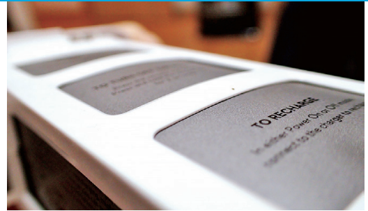
写真1 高温で膨張してしまったドローンのバッテリー
