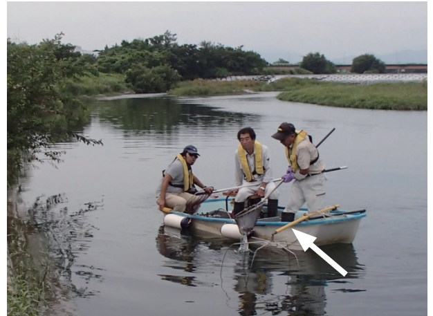
写真 1 自作の電気ショッカーボート 購入価格を抑えるため、電極を取り付けるブーム（ポール、矢印）は陽極のみ。
