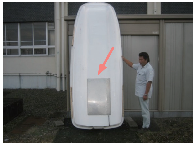
写真 2 ボート底の陰極（矢印）ステンレス板を設置している。
