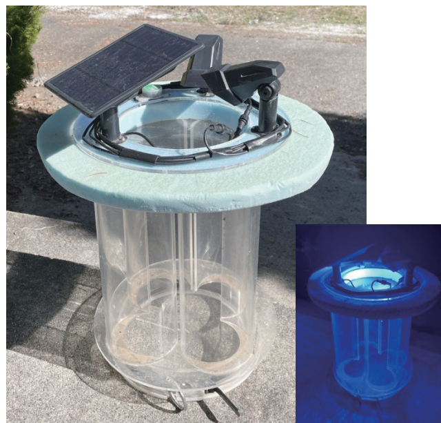
写真1. ライトトラップ本体と夜間に光る様子（右下） 明暗センサーにより暗くなると光る
