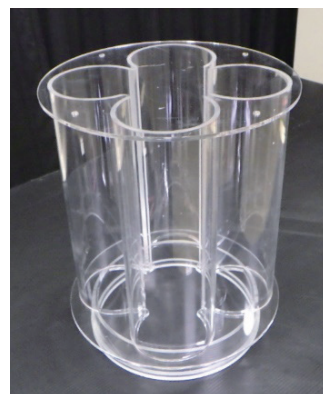
写真3. ライトトラップ本体部分。上面から見ると四ツ葉の形
