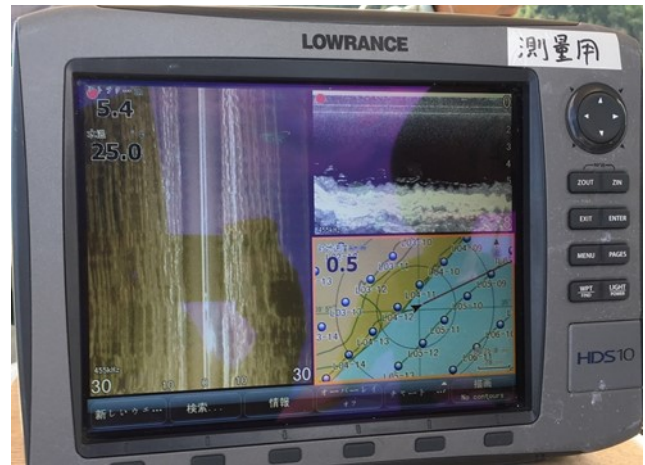
図3-(2)-2. 測量中のストラクチャスキャン付きGPS魚探(Lowrance)画面上のサイドスキャンの地形画像(左)、ダウンスキャンの地形画像(右上)、船の位置と調査点とラインの図(右下)
