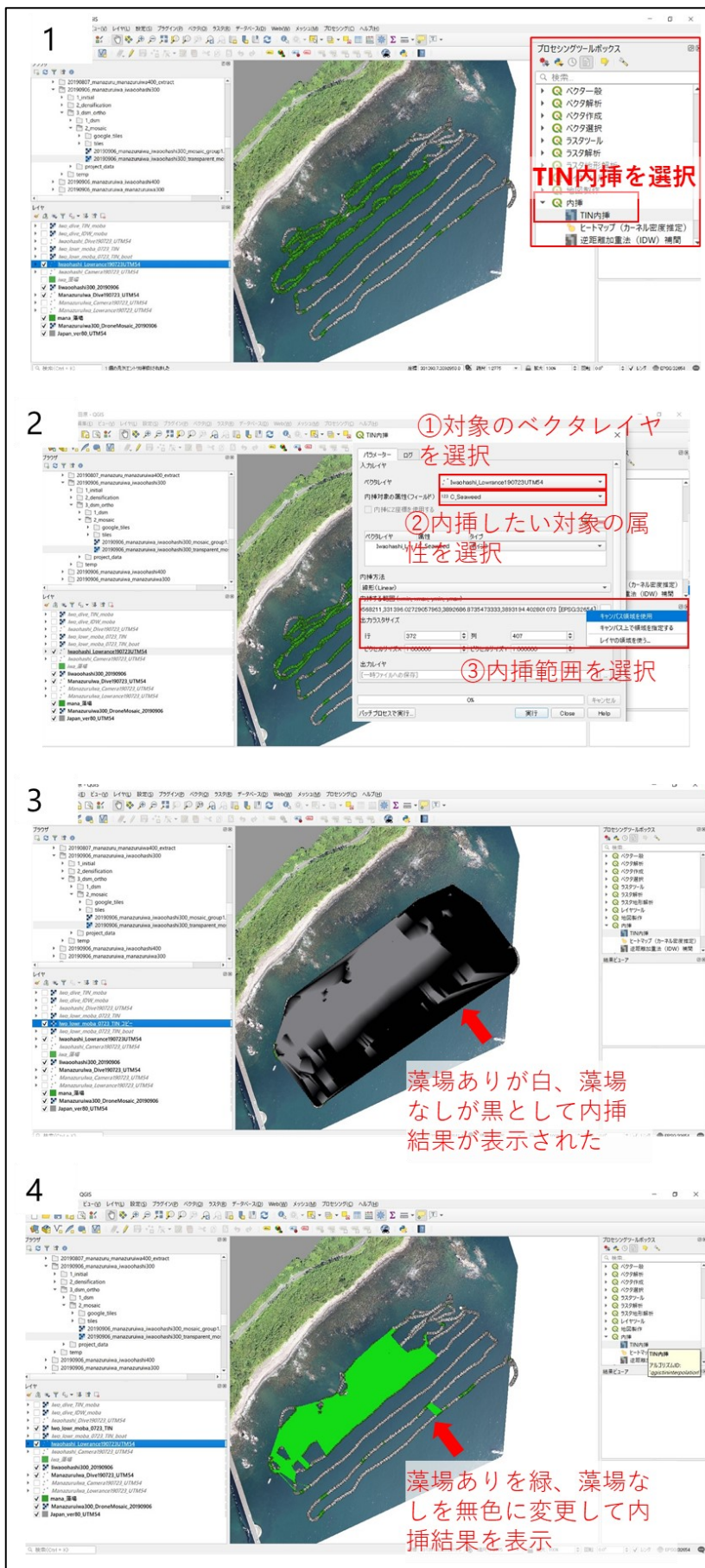
図 3-(2)-7. 魚探データから藻場分布を内挿して推定する手順 (QGIS バージョン 3.10.0)
