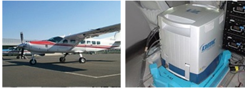
図 3-(4)-1. 測量用の航空機と Digital mapping camera (国際航業株式会社運営解説サイト MoGIST より)
