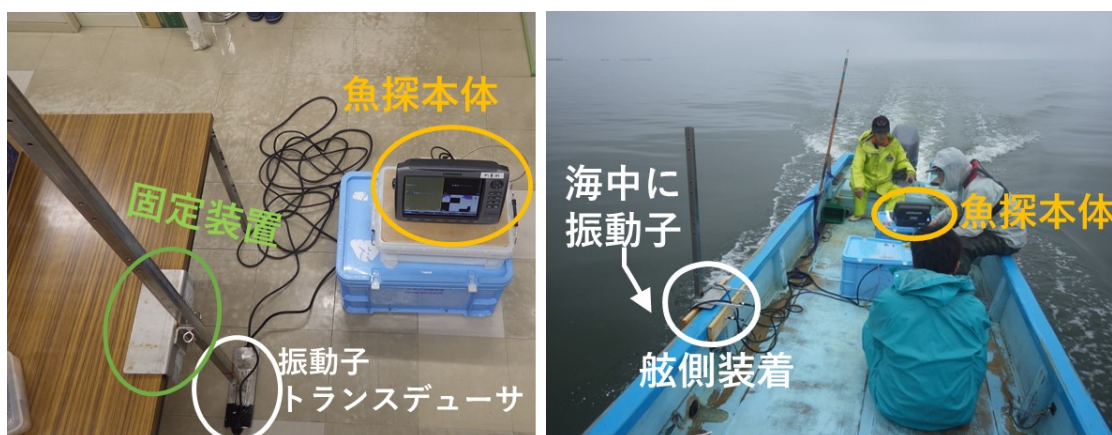
図 3-(2)-1. 魚群探知機の各種の名称と船上での調査の様子
