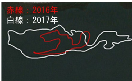
図2 ハンディGPSによる藻場範囲の計測と表示例。(a)藻場の輪郭を視認できる場合は、海面を泳ぎながら位置を記録する。(b)記録した位置データを用いて、経年的な藻場範囲の変化を表した例。
