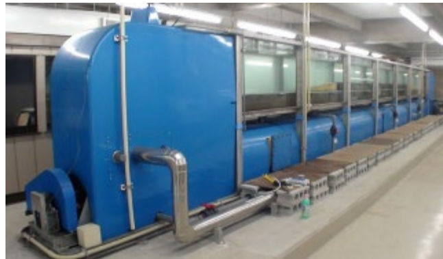
図: 2.1-1 振動流水槽
