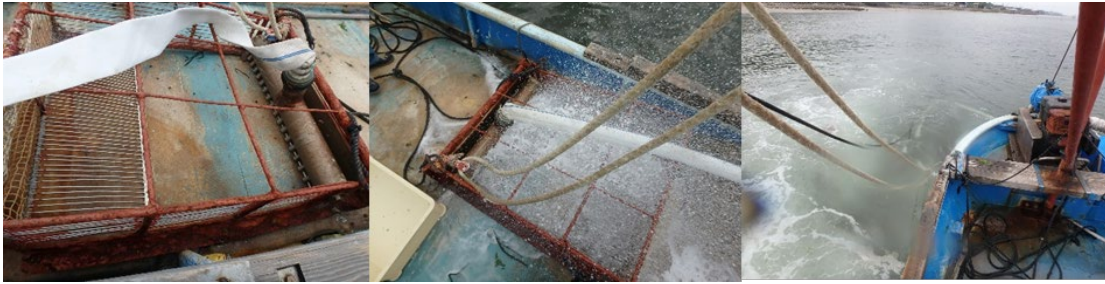
図 11.2-3 試験に用いた漁具（左）とポンプ稼働時の水流噴射（中）、および曳航試験時の様子（右）
