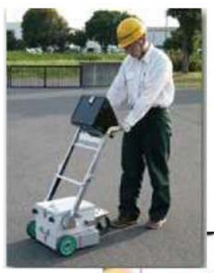
地中レーダー機器（カートタイプ）
