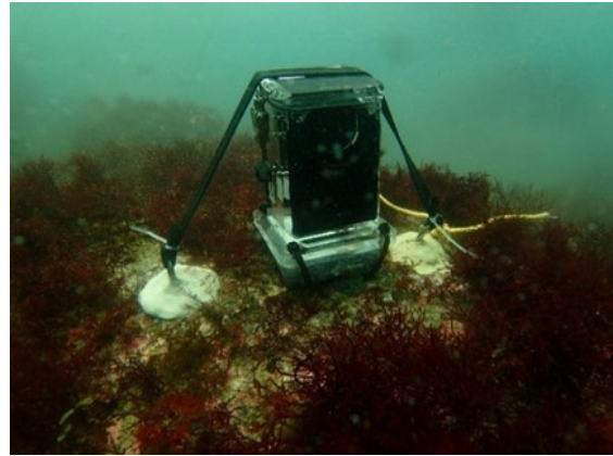
図 7-B2-8 タイムラプスカメラの固定
