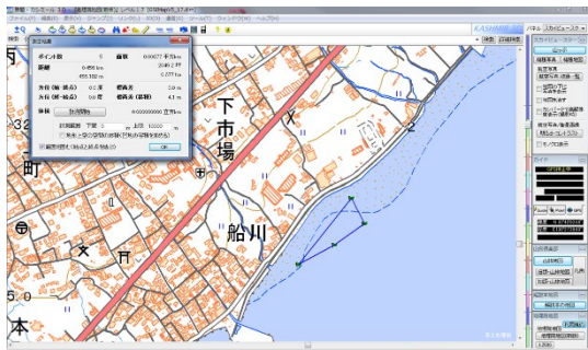
地図ソフト(カシミール3D)を用いて、記録したデータを表示させて面積を計測する。
