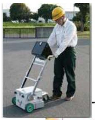
地中レーダー機器（カートタイプ）
