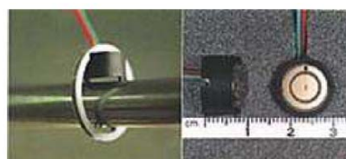
腐食センサー
