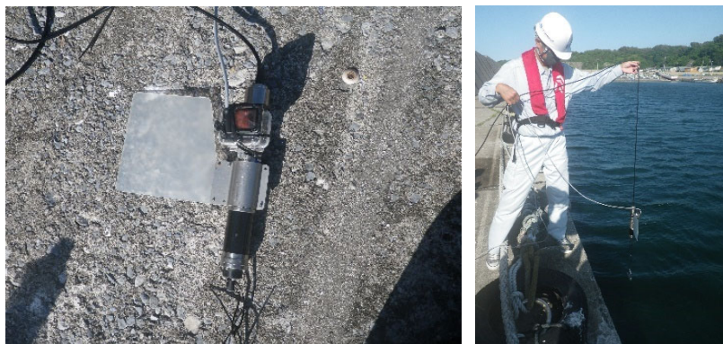
図 4-10 垂下式カメラ（ロープ式）による撮影状況
