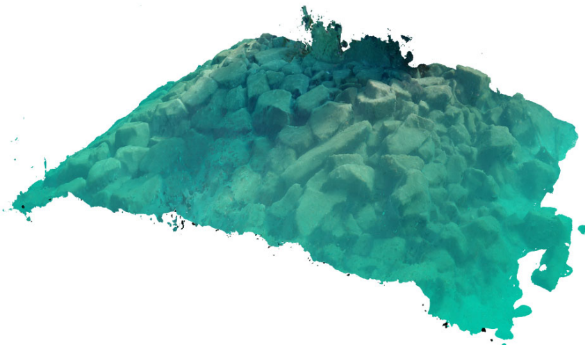
図 4-20 市販ソフトにより結合した画像を3次元化した例（防波堤の被覆工）
