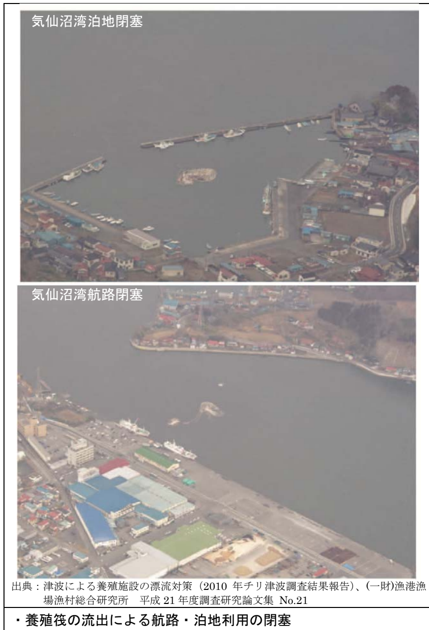
写- 1.28 2010年チリ地震津波に伴う養殖筏の漂流による、航路泊地の埋塞(宮城県気仙沼市)
