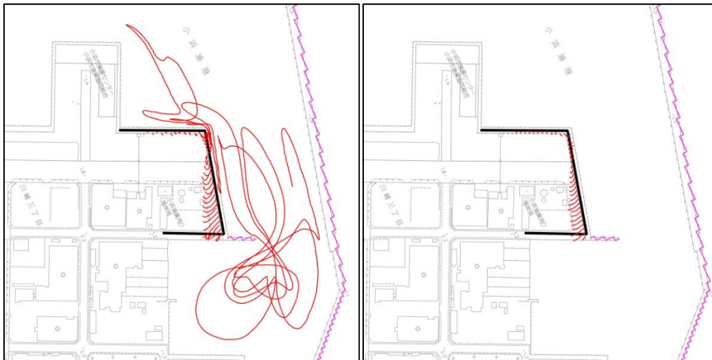
図- 3.40 北側用地における津波漂流物(車両)の軌跡
