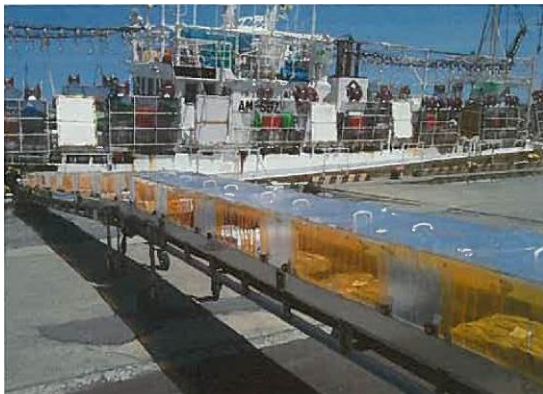
写真-参.1 フード付きベルトコンベアの例（H 漁港）
