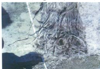
図③ シンカー角部との接触による切断
