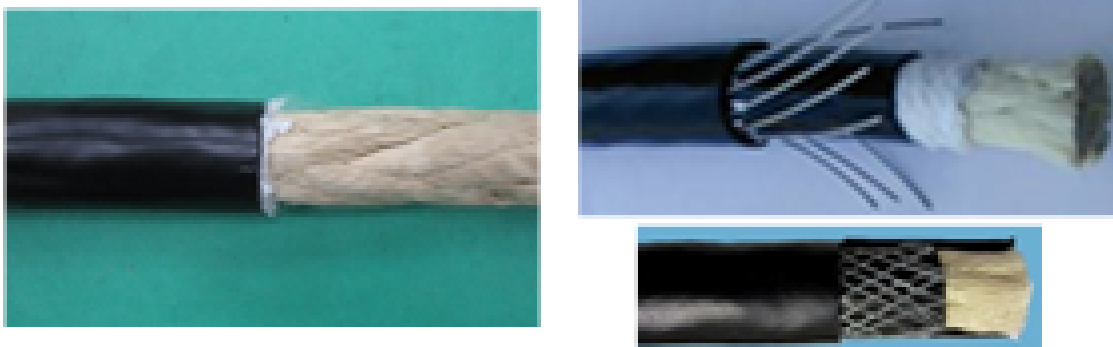
図 3-1 係留索の補強対策（左：樹脂被覆、右：ワイヤー外装）
