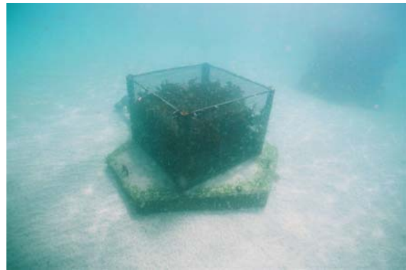
【魚類侵入防止用の金網】
