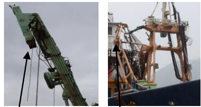
左舷船尾のクレーンのブーム破損 右舷船首部のブーム曲損
