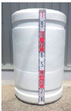
海洋生分解性プラスチックを用いたフロートの試作品と実証試験
