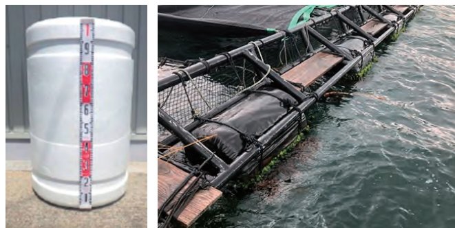
海洋生分解性プラスチックを用いたフロートの試作品と実証試験 （写真提供：（公財）海と渚環境美化・油濁対策機構）
