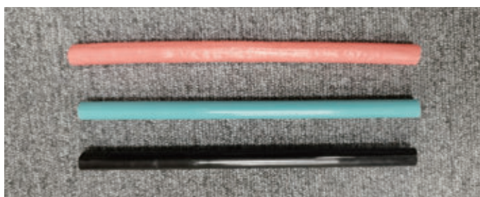
海洋生分解性プラスチックを用いたカキパイプ（養殖用資材）
