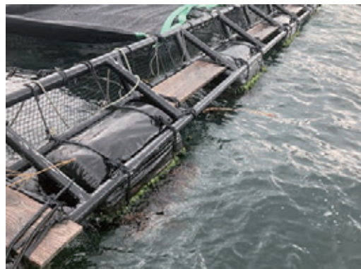
海洋生分解性プラスチックを用いたフロートの試作品と実証試験
