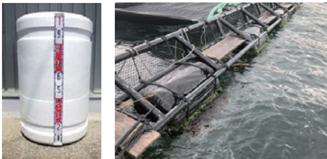
海洋生分解性プラスチックを用いたフロートの試作品と実証試験 (写真提供：公益財団法人海と渚環境美化・油濁対策機構)
