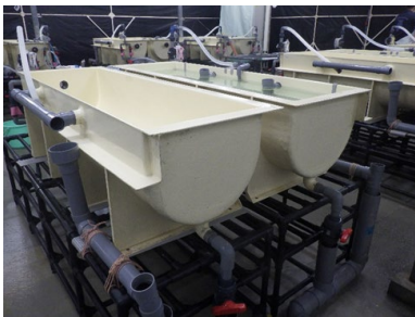
開発したウナギ種苗量産用水槽
