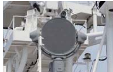
長距離音響発生装置(※) (※)高い指向性を持ち、遠くまで音声を届ける設備。退去警告等に用いる。
