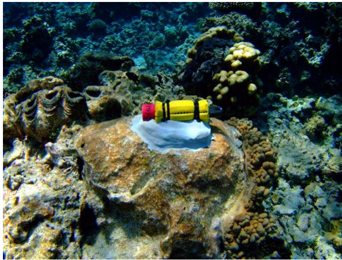
写真Ⅱ-1-2-4 水温計設置状況
