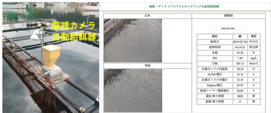
図Ⅱ.2.16 Webカメラ、自動給餌器の外観(右)及びスマートフォン上の遠隔給餌画面(左)
