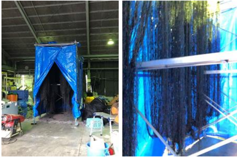
図10 使用済みテトロン漁網の乾燥（左：簡易乾燥室、右：乾燥室内部）
