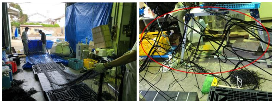
図9 使用済みテトロン漁網における撚糸（仕立て糸）の取り外し
